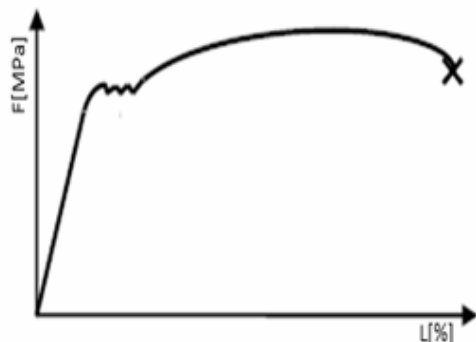
Rysunek. 4.1 Materiał z wyraźną granicą plastyczności.
